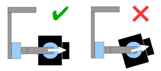
Se la videocamera è in una posizione errata, dovrai regolare il parametro dell'offset. Inserisci valori manualmente o utilizza il pulsante AUTO.
