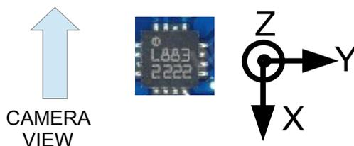
В параметре “Axis TOP” укажите, какая ось смотрит вверх. В параметре “axis RIGHT” укажите, какая ось смотрит вправо, если смотреть по направлению съемки камеры (в примере на рисунке, Axis TOP=Z, RIGHT=Y). Запишите настройки в плату и дождитесь ее перезагрузки.
